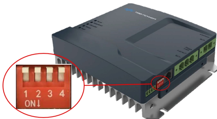
Fig.319 Inställning av kommunikationsadress via DIP-omkopplare för DM-serien
