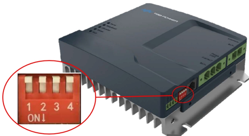
Fig.319 Innstilling av kommunikasjonsadresse via DIP-bryter for DM-serien
