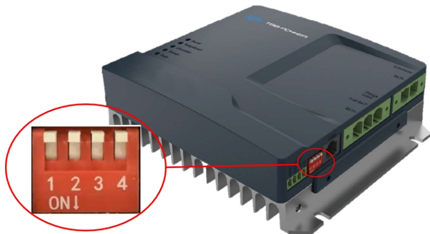
Fig.319 Indstilling af kommunikationsadresse via DIP-kontakt på DM-serien
