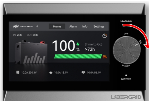
Fig.41 Strømbryteren på LIBER43
