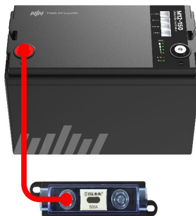
Figure 2-7 Connexion du câble d'alimentation à la borne (+) de la batterie lithium
