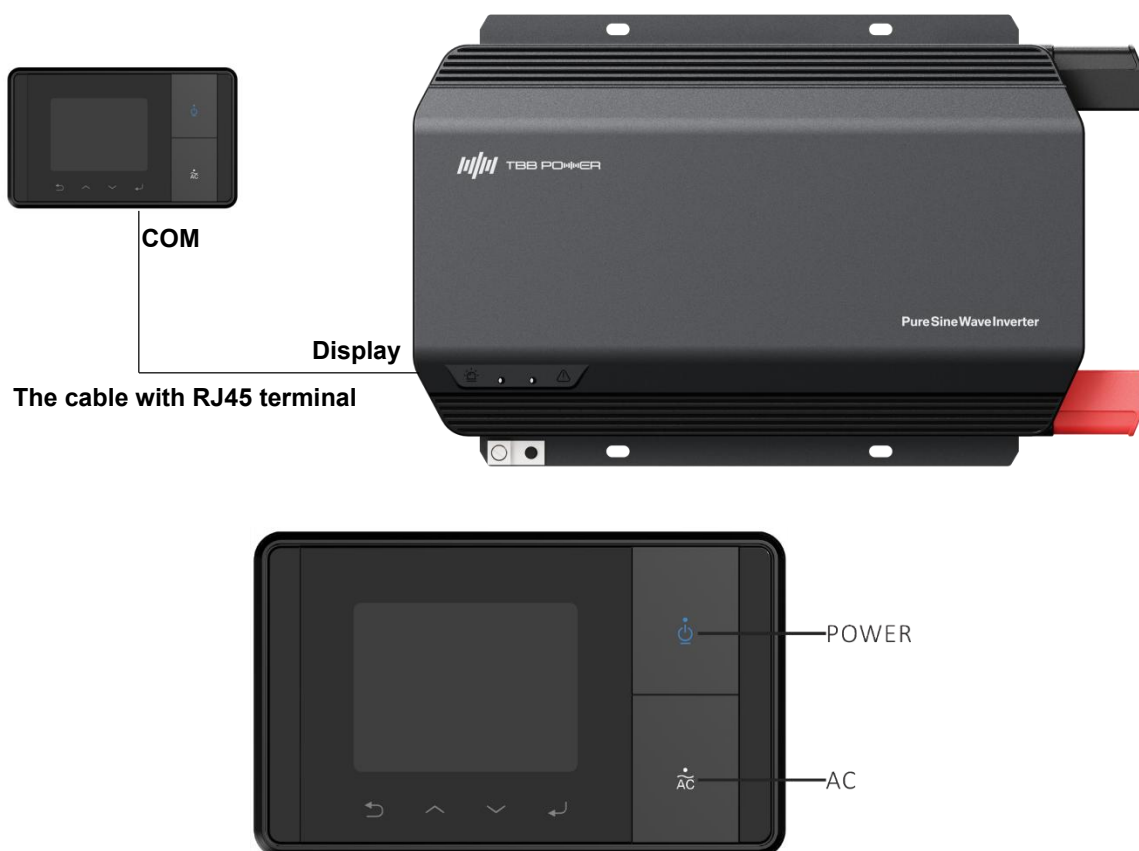
Abbildung 2-6: Anschlussdiagramm zwischen NH-Wechselrichter und VS28-LS-Display
